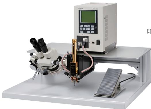
印刷电路板修理装置
